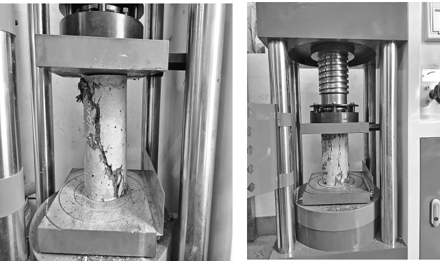
Hình 13. Thí nghiệm nén các mẫu UHPC
