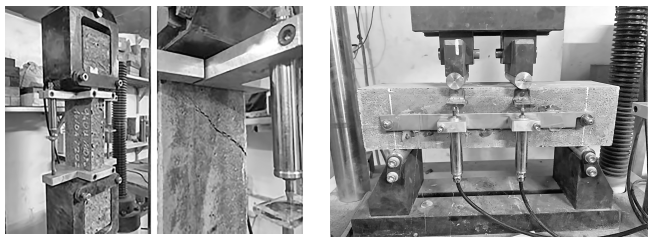
Hình 16. Thí nghiệm kéo và uốn các mẫu UHPC
